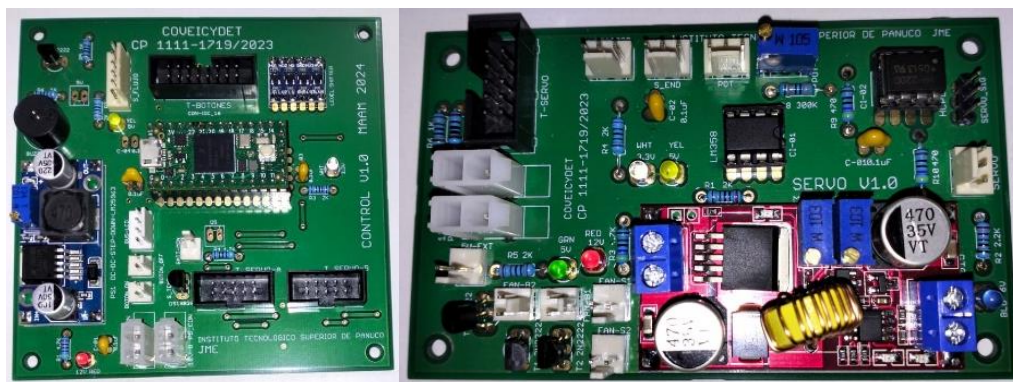
Figura 10.- Tarjetas de control y de servomotores finales ensambladas.
