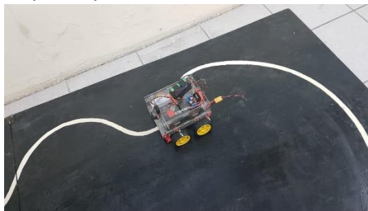
Figura 9. Prototipo de mini robot móvil terrestre en modo robot seguidor de línea.
