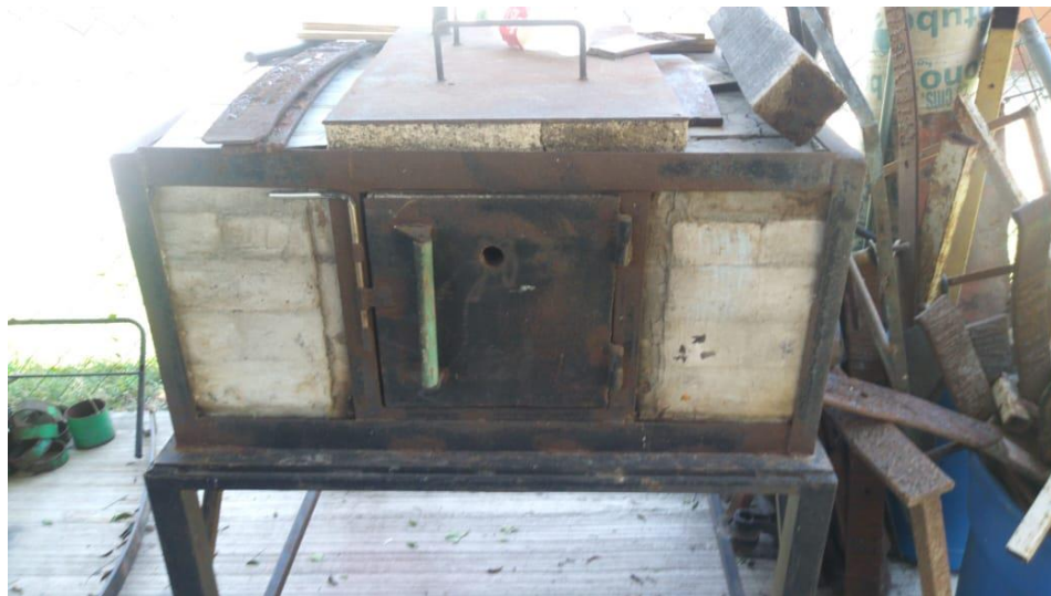
Figura 1.- Horno didáctico de fundición del Laboratorio de Ingeniería Industrial del ITSP.
