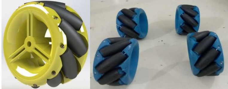
Figura 8. Diseño de rueda omnidireccional de (Innoart 2016) y ruedas fabricadas por impresión 3d.
