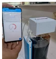
Figura 8. Medición de H 2 S en muestra de hidrocarburo.
